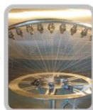
IP×1/2測試： ■ IP×1、IP×2負壓吸引設計 ■ 獨特的噴嘴不易堵塞
